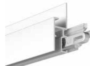
Le R30 est un rail professionnel de suspension murale qui convient parfaitement aux galeries et aux musées. Il est fabriqué en aluminium de qualité supérieure pour une capacité de 50 kg par mètre (dimensions 34,8 x 11,5 mm).
